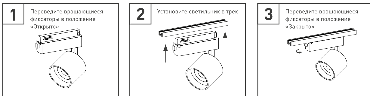
Рис. 3. Установка и подключение светильника
